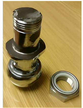
▲ Fig. 2. Fatigue fracture
