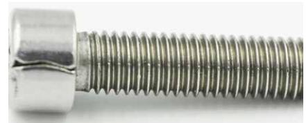
圖3：線材接縫造成的頭部裂紋示例（注意看接縫已穿過了螺紋）
