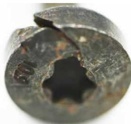
圖 5：剪切爆裂示例
