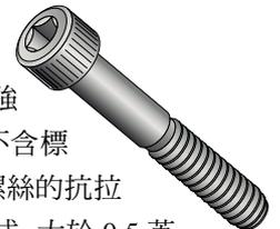
歐製設備上的公制內六角頭螺絲可能使用不同性能等級的產品，包括：8.8、10.9、11.9 和 12.9。這些數字標記在頭部的側面或頂部。**非常重要**的是去識別出**內六角頭螺絲的性能等級**以便正確更換，並確定接合介面上的所有其他內六角頭螺絲是否具有相同的抗拉強度。
