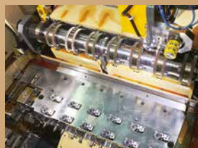
Finger Open/Close Cam Auto. Adj. 夾仔開啟凸緣電動調整
