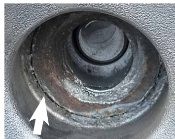
照片 8. 使用氣動工具進行過多的衝擊也會使螺帽周圍的鄰近區域破裂
