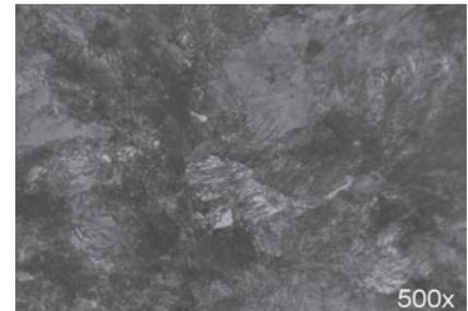
圖5 1070M 26mm條鋼盤元組織
