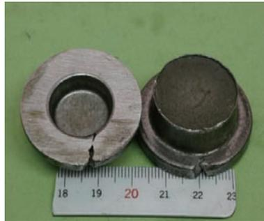
圖2 凸緣螺帽冷打(鍛)裂外觀
