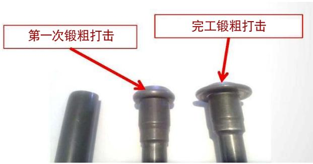
图3：第一次和完工锻粗打击的范例
