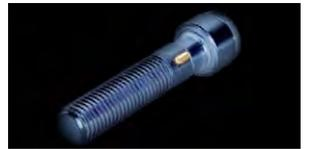
接合技术,该公司不需透过接著剂就可将感测器埋入螺栓内。用户可用传输线将它连接到专用量测软体,以评估加工过程中的异常或问题。由於荷载传递的路径上并未受到高分子化合物的阻挡,所以荷载会直接传递到感测器上,达成高精度的荷载量测。此外该感测器拥有优异的耐用性和抗冲击性,适用于充满水油粉尘的环境。
