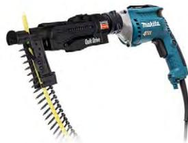
建商和包商可以因此Quik Drive PRODW乾墙系统获取的优点有:整串螺丝进料机制,设计用来提供稳定和效率的螺丝输送、可达到精确钻入深度的防松深度调整,以及可应用于难以到达区域紧固的全向旋转钻具转接头。弯折链带让螺丝避开工具前鼻部,可避免原料表面刮伤受损。其硬化钢制的进料爪也增加其可靠性。
