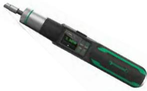
TORSIOTRONIC是市面上第一台电子兼机械式扭力起子,结合电子量测的精准度和机械式扳机按压操控的方便性。专利的扳机在达到目标的扭力值时会松开并送出音声或触感式讯号。它整合了棘轮式钻头固定座,拥有80齿的棘轮,所以棘轮角度最小只有4.5度,作业敏感度特别高,适合用在双手难以触及到的扣件。该起子的精准度就如同一把电子扭力工具,它拥有齿列式棘轮,众多程式设定的选项,以及USB介面,因此很适合用来记录工序、施加小扭力或执行复杂的紧固程序。该起子有四种扭力版本,分别是12-120 cN m、30-300 cN m、60-600 cN m、100-1000 cN m。
