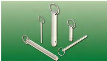
这次推出的止动销带有环状构造和手柄，相容于商用钻头的公差，且搭载弹簧加压的球状物会在安装或取出止动销时自动缩回。止动销的直径3/16"~1"，拉拔强度4~40 lb，握持长度1/2" to 6" (依直径而定)。材质为C1144钢(搭载钢制开口环)或303不锈钢(搭载316不锈钢环)。
