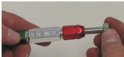
塞规必须符合Z公差。通侧的公差必是正公差；不通侧的公差必须是负公差。通侧圆柱塞规必须无阻的插入并通过产品的长度。不通侧圆柱塞规不可插入。
