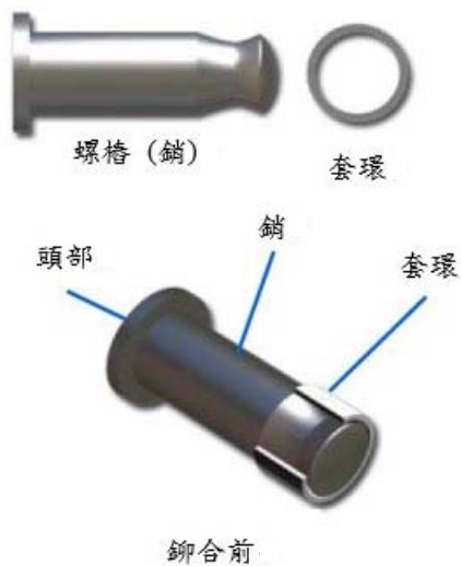
圖8 高剪切鉚釘結構
