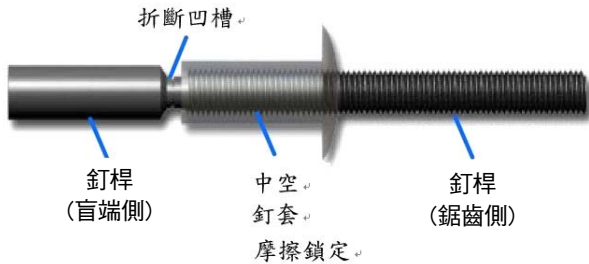
圖4 自塞摩擦鎖定拉釘
