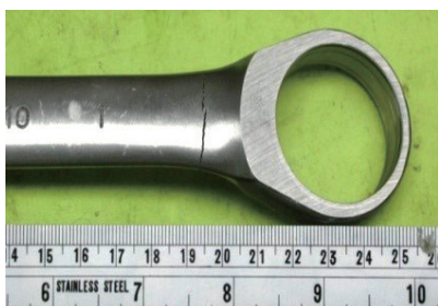
圖3 扳手壓彎斷裂外觀
