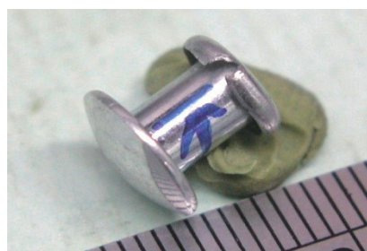
圖1 鉚釘冷打裂外觀
