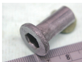
圖5 扣件頭部外圍表面橘皮外觀
