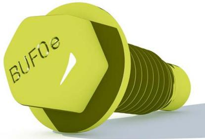
Bulten使用具備了整合溫控軋製和添加維合金元素的冷鍛鋼進行生產。同時藉由精密計算的形變硬化，讓Bulten在冷鍛後可以不經淬火和回火程序仍能生產出強度等級達800~1000 MPa的產品。
