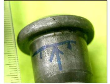
圖7 螺栓頭部輪緣發生45°冷打硬裂
