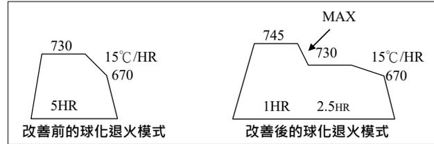
圖11  $\phi 13\text{mm}$ 以下小尺寸碳鋼改善前、後之球化退火模式
