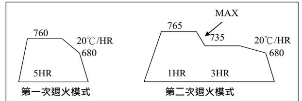
圖8 改善前：中低碳合金鋼之第一次退火模式與第二次退火模式
