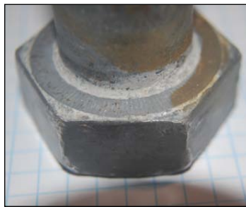
图五：脊状结构咬住了螺栓头部
